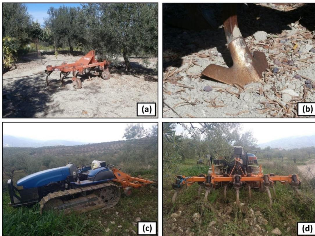
**Figura 6.** Aperado de labranza:(a) cultivador de 9 brazos flexibles semi-suspendido, (b) detalle reja cultivador, (c) vista lateral del conjunto y (d) vista trasera del conjunto (Fuente: Fotografías el autor).
