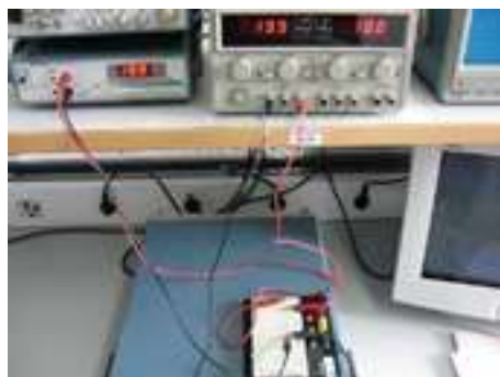
Figura 4-c. Testeo de un circuito implementado sobre protoboard. El circuito aparece conectado a una fuente de alimentación y a un multímetro (Imagen cedida por Francisco Javier Vizcaino Martín)
