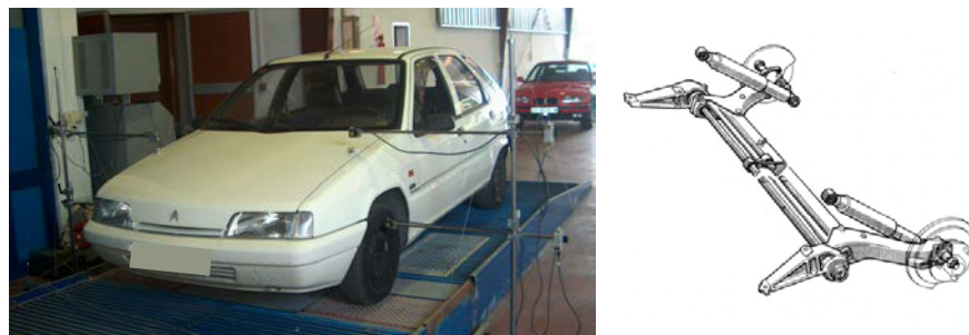
Figura 4-26. Citroen ZX. Suspensión delantera McPherson. Trasera semi-independiente.
