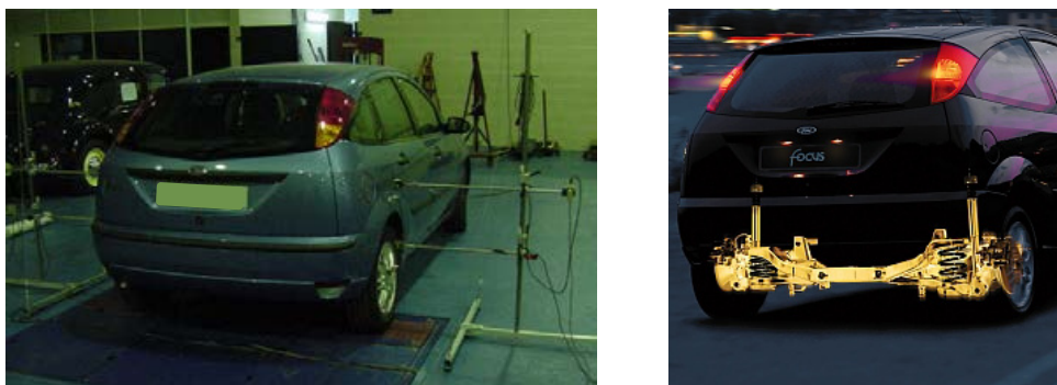
Figura 4-27. Ford Focus. Suspensión delantera McPherson. Trasera independiente con barra estabilizadora.
