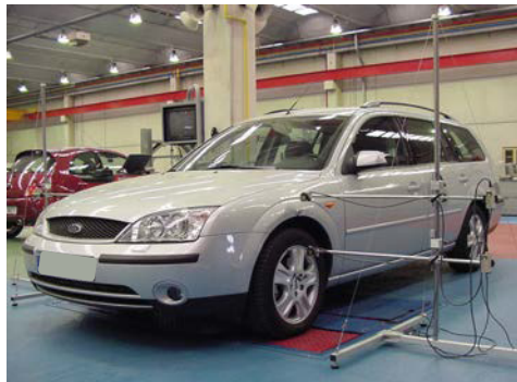
Figura 4-29. Ford Mondeo. Suspensión delantera McPherson. Trasera independiente con barra estabilizadora.
