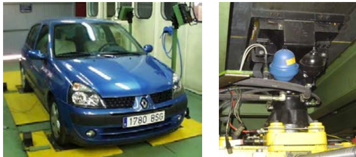
Figura 2-14. Banco para caracterizar el nivel de confort (NISSAN TECHNICAL CENTRE EUROPA SPAIN).
