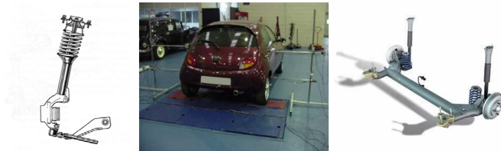
Figura 4-25. Ford Ka. Suspensión delantera McPherson. Trasera semi-independiente.
