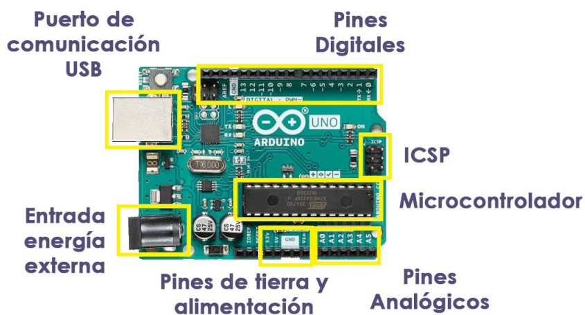
Figura 1: Componentes del Arduino UNO
