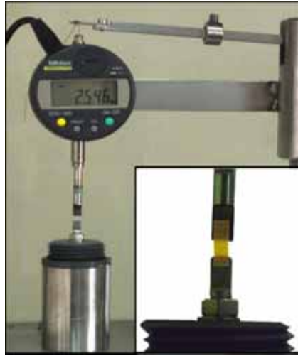
Figura 2.5: Imagen del sistema de sujeción diseñado para fijar las muestras de cutícula en el extensiómetro
