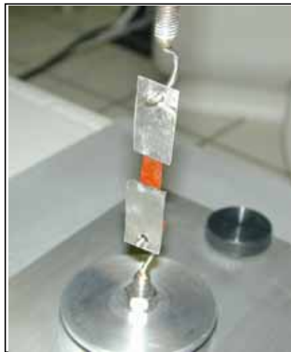
Figura 2.6: Imagen del sistema de sujeción diseñado para fijar las muestras de cutícula en el extensiómetro
