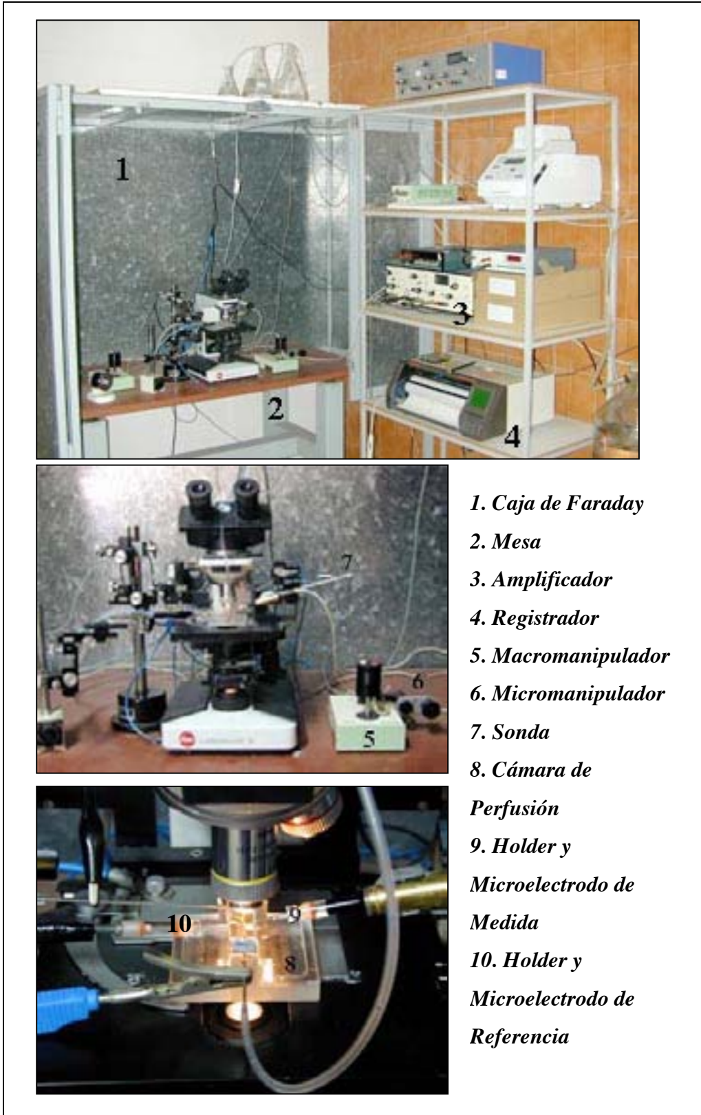
Figura 8. Componentes de un puesto de electrofisiología. Detalle de accesorios del microscopio, cámara de perfusión y microelectrodos.
