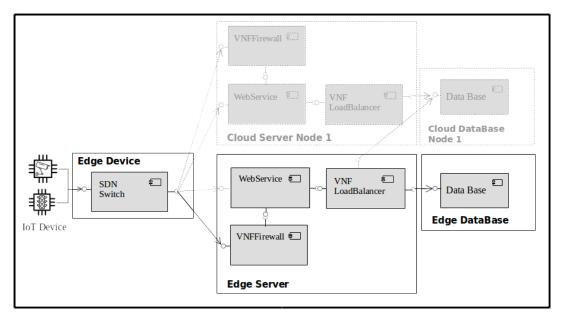
FIGURE 7.9: IoT Scenario Scheme With Firewall Edge
