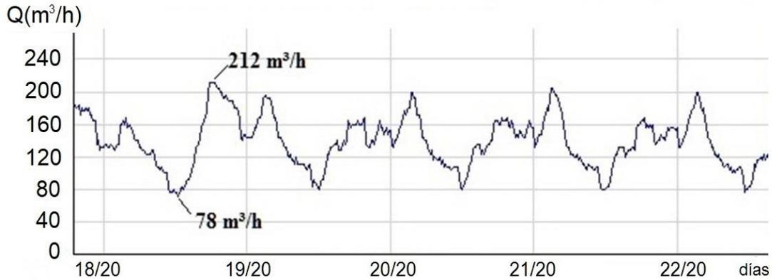
**Figura 32. Detalle de la fluctuación de caudales durante el mes de septiembre.**
