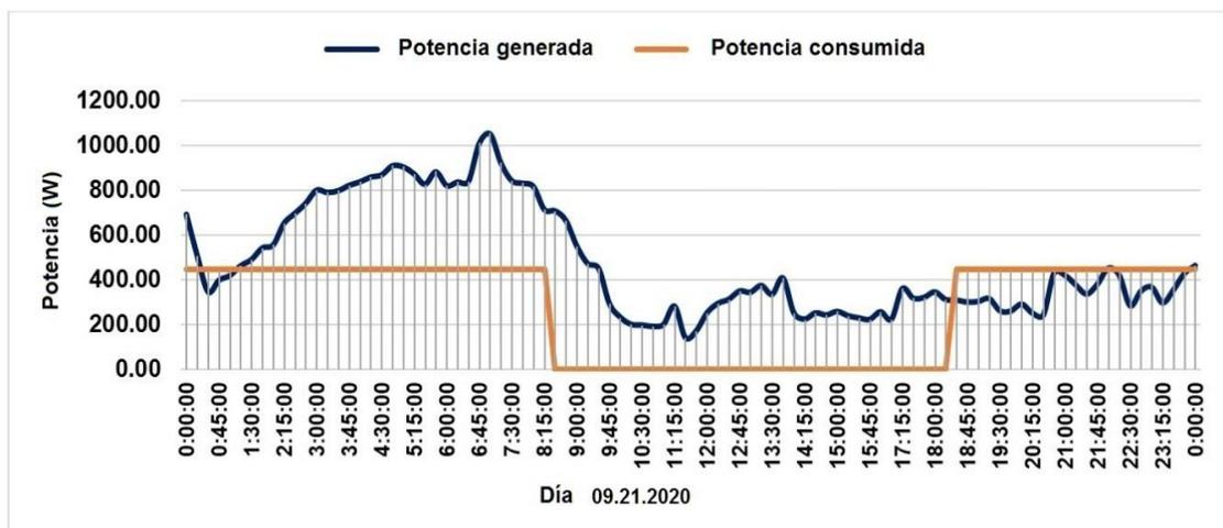
**Figura 34. Energía producida y consumida en un día medio de septiembre (con un consumo teórico de 14,5 h de funcionamiento del alumbrado, con la noche más larga del año como peor escenario). Fuente: Elaboración propia (2022)**
