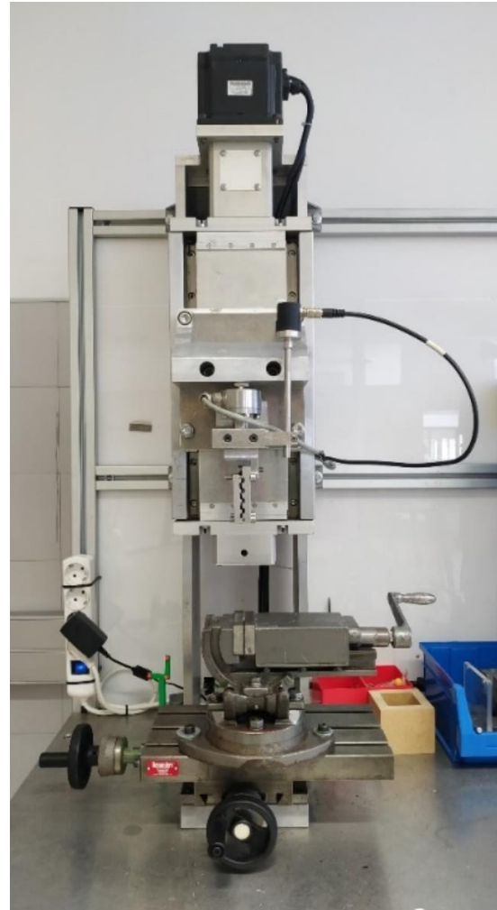
Figura 2. Banco de ensayos de tracción/compresión uniaxial de construcción propia.
