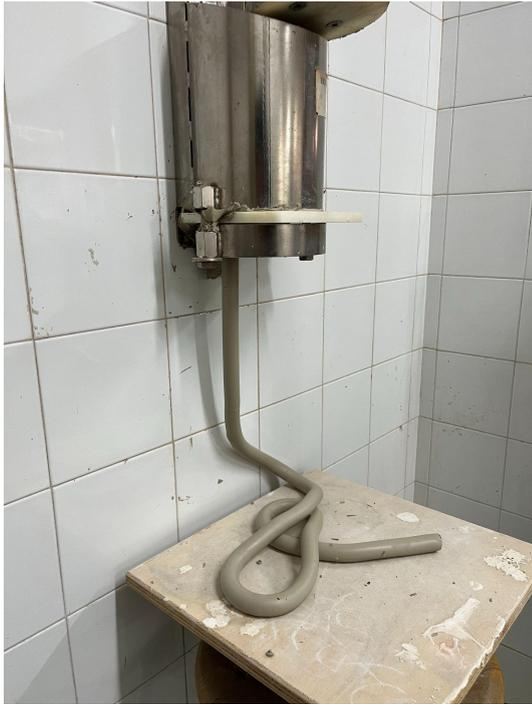
Fig.13. Proceso de extrusión
