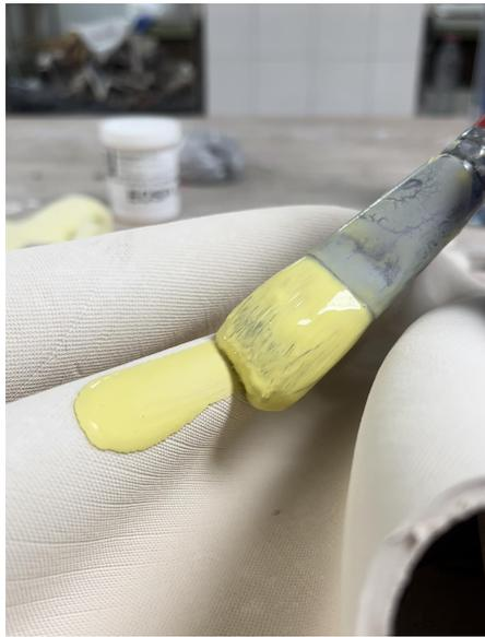
Fig.12. Proceso de aplicación de esmalte cerámico
