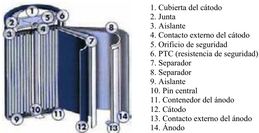
Figura 1.3. Estructura de una batería de ión-litio
