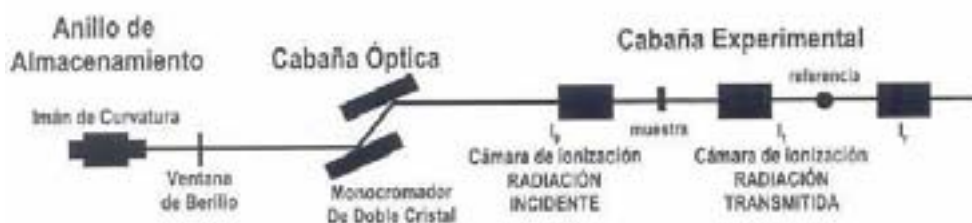
Figura 2.29. Representación esquemática de la estación de trabajo BM29 del European Synchrotron Radiation Facility (ESRF), mostrando el dispositivo utilizado para realizar las medidas de EXAFS estático en modo transmisión
