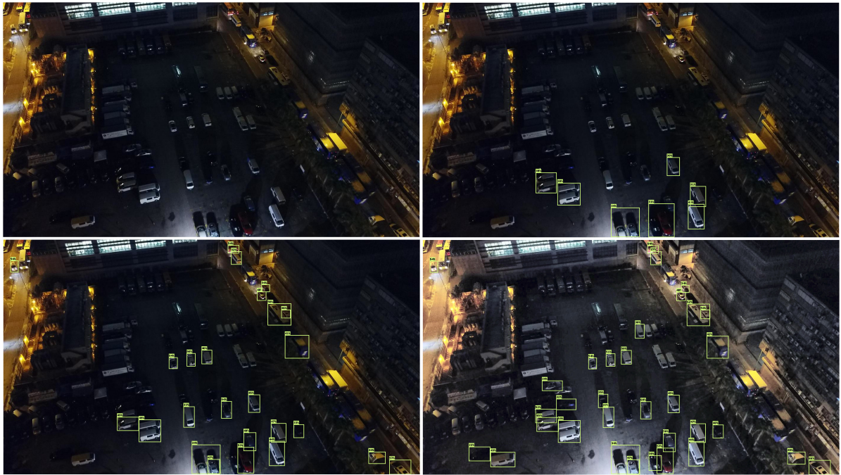
Figura 19: Comparativa obtenida en una imagen de baja luminosidad (representada en la esquina superior izquierda), entre el modelo original de base (esquina superior derecha) y nuestra propuestas PSR (esquina inferior izquierda) y PSRFLUT (esquina inferior derecha).
