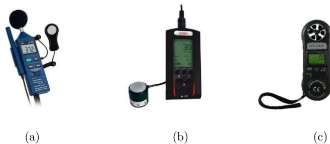
Fig. 2.3. Dispositivos utilizados para medir las variables involucradas en el estudio: (a) medidor de ambiente PCE-EM882 (temperatura), (b) Solarímetro Kimo SL 100 (nivel de irradiancia), (c) PCE-AM81 anemómetro portátil (velocidad del viento).
