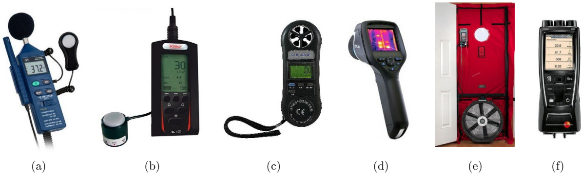
Fig. 1.12 Aparatos de medición utilizados a) Medidor de ambiente para medición de temperatura y humedad (Modelo PCE-EM882); b) Solarímetro para medición de niveles de irradiancia (Modelo Kimo SL 100); c) Anemómetro portátil para la obtención de la velocidad del viento (Modelo PCE-AM81); d) Cámara termográfica para detección de fallas en aislamiento y puentes térmicos (Modelo FLIR E50); e) Ventilador de puerta con manómetro digital de precisión para test de estanqueidad de edificios (modelo DG-700); f) Instrumento de medición multifunción para la calibración de los datos de T, HR y CO 2 de sensores de baja sensibilidad (Testo 480).
