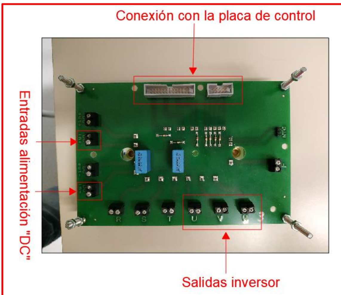
Figura 33. Placa de potencia de los equipos inversores (cara superior).
