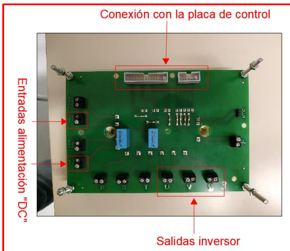
Figura 369. Placa de potencia de los equipos inversores (cara superior).
