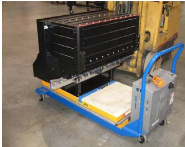
Ilustración 19. Paquete de baterías Tesla Roadster (Berdichevsky et al., 2007)
