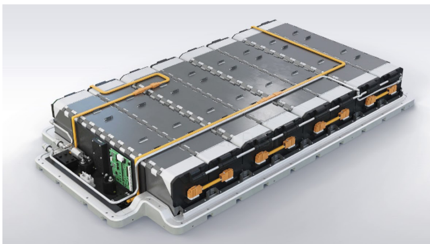
Ilustración 5. Modular battery pack de BMW i3 (Technik, 2018)
