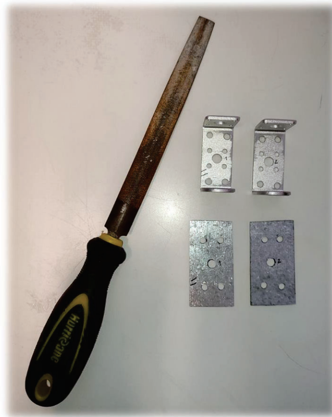
Figura 51 – Lijando elementos metálicos (elaboración propia)
