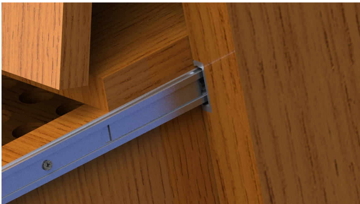
Ilustración 41. Vista III: Detalle del pin de bloqueo desactivado. Fuente: elaboración propia.
