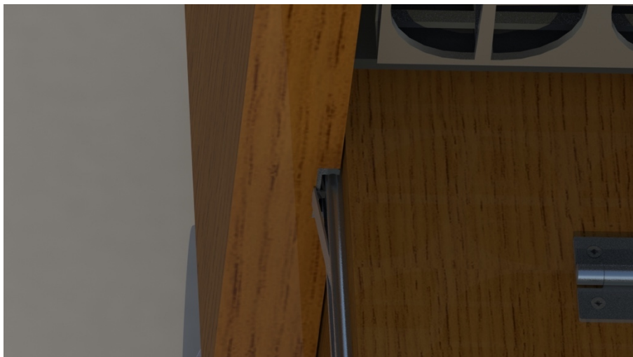
Ilustración 47. Pletina/Pin de bloqueo en posición activa. Fuente: elaboración propia.
