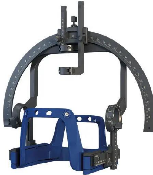
Figura 6. Marco Lexell o CRW empleado para la Neurocirugía de PD, Imagen procedente de: “Marco de estereotaxia Leksell® Vantage™ Elekta” ( https://www.medicaexpo.es )
