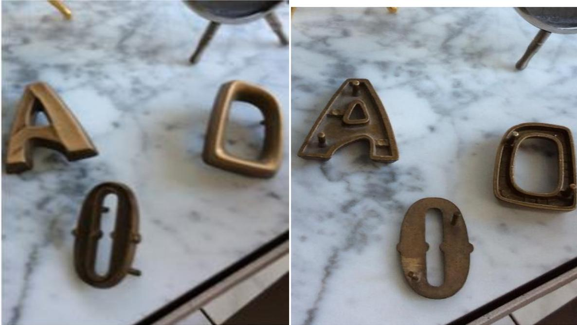
Figura 34 y 35. letras en anverso y reverso, con los pernos para ser insertadas en la piedra. Empresa funeraria La Esperanza (elab.
