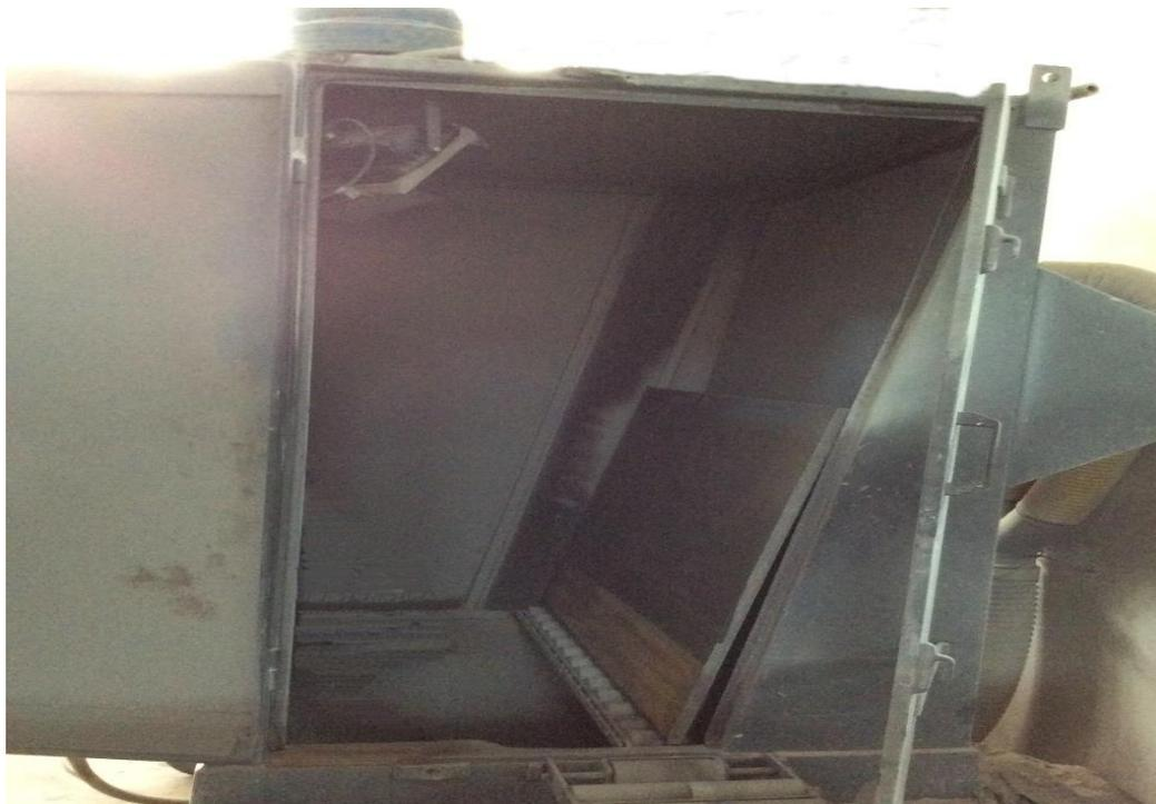
*Figura 26. Máquina para el proceso de chorro de arena manual abierta. Empresa Mármoles y Granitos A. Suarez (elab. propia)*
