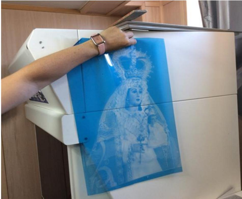
*Figura 30. Máquina Insoladora y transparencia. Empresa Mármoles y Granitos A. Suarez. (elab. propia)*
