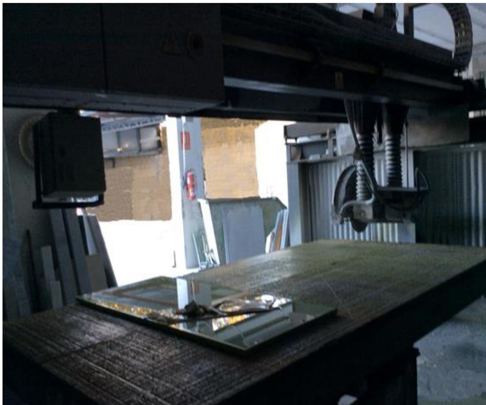
*Figura 10. Máquina cortadora de la piedra. Mármoles La Esperanza. (elaboración propia)*
