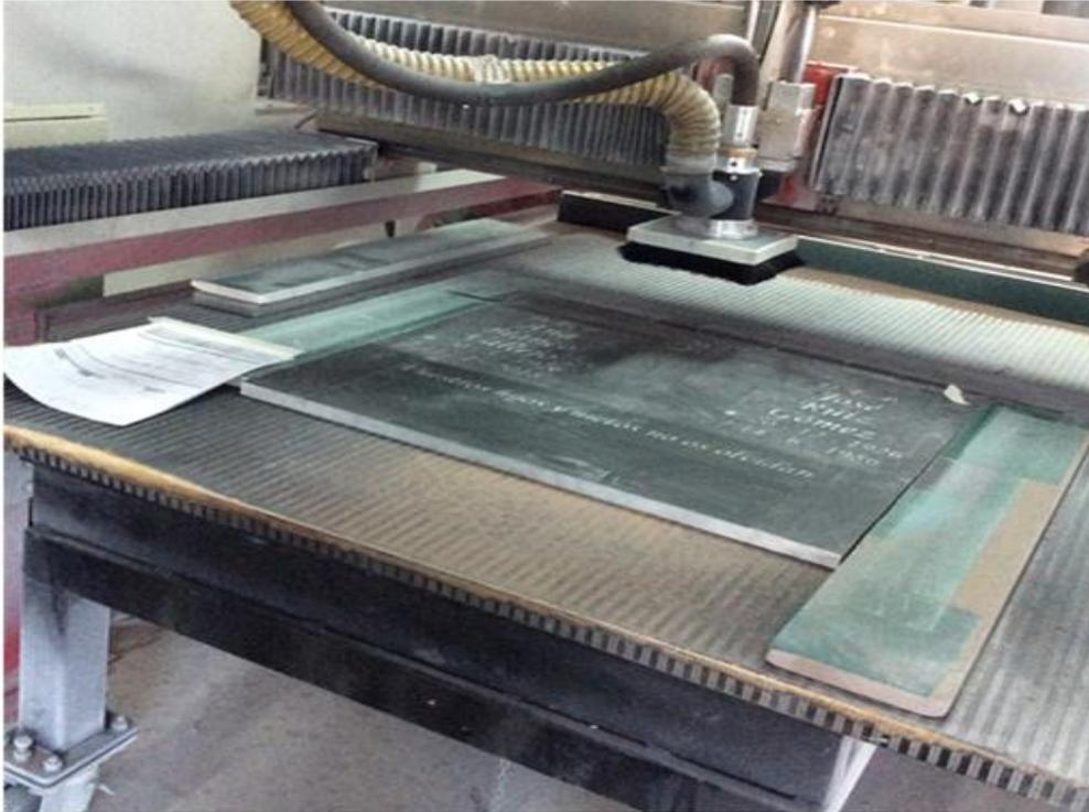
*Figura 29. Máquina eléctrica para el proceso de chorro de arena. Empresa funeraria La Esperanza. (elab. propia)*
