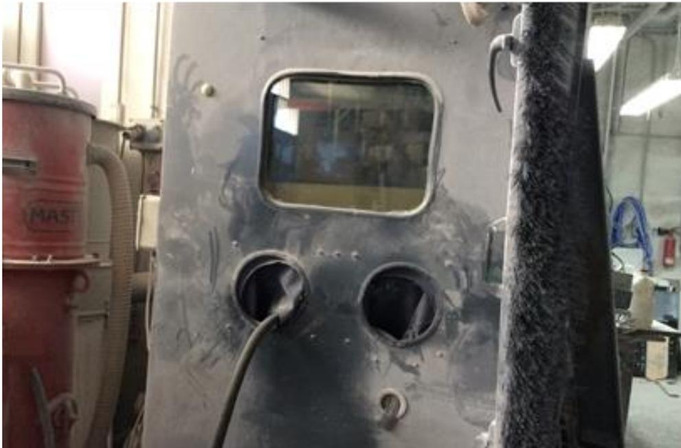
Figura 27. Máquina para el proceso de chorro de arena manual cerrada. Empresa Mármoles y Granitos A. Suarez (elab. propia)
