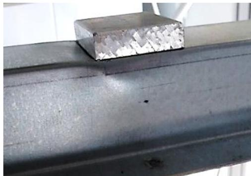
*Figura 3.2: Estado de la viga nº1 tras el impacto a 4 m/s.*
