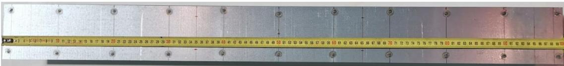
Figura 3.10: Disposición de los puntos de soldadura.
