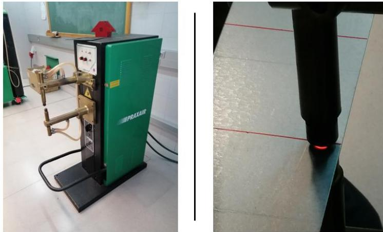
Figura 3.11: Máquina de soldadura por puntos modelo Praxair MPP-30-M (izquierda) y proceso de soldadura por puntos (derecha).
