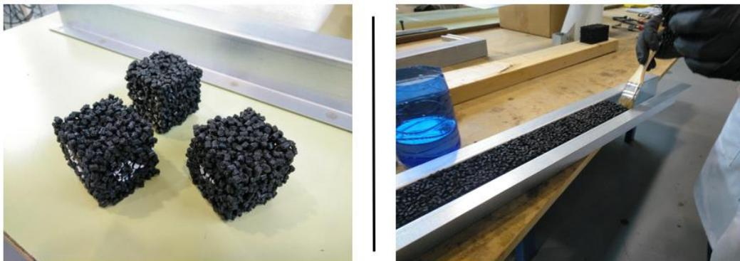
*Figura 3.9: Aglomerados de caucho reciclado y poliuretano (izquierda) y proceso de unión del aglomerado a la viga (derecha).*
