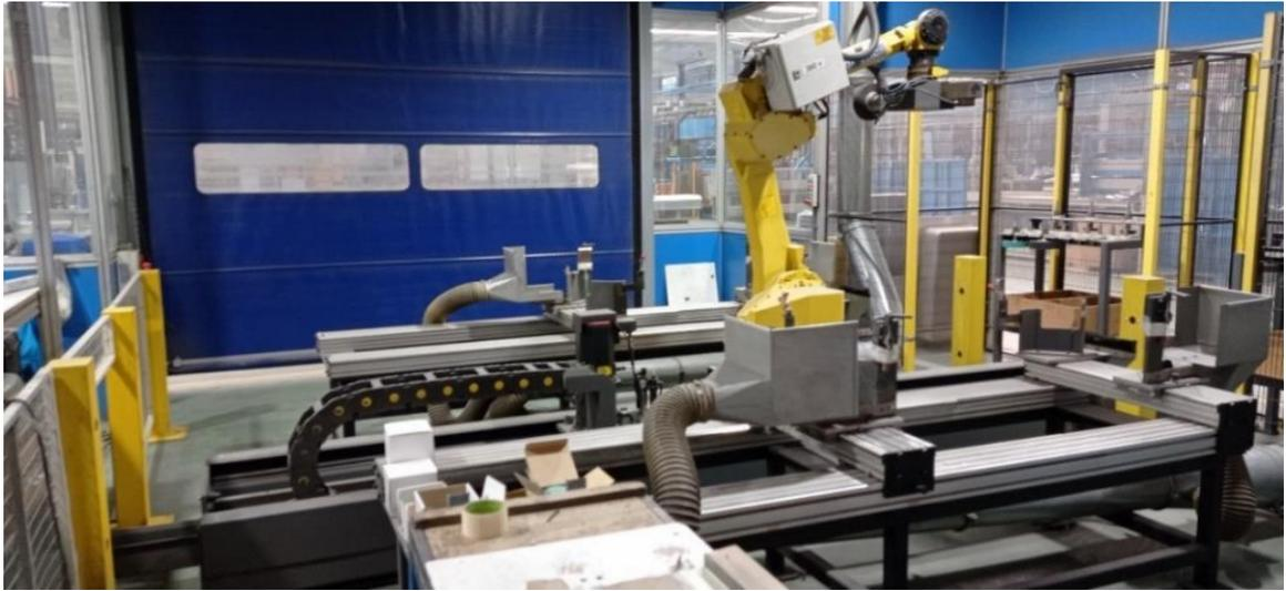
*Ilustración 16. Robot de repasado de soldadura IT Robotics*
