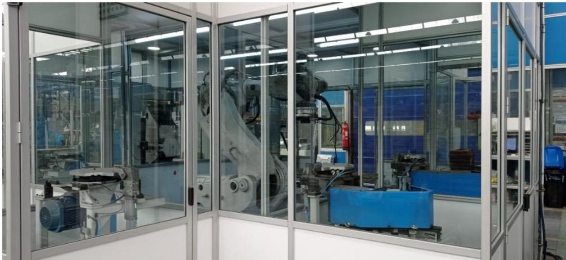
*Ilustración 17. Robot de repasado de soldadura Autopulit*
