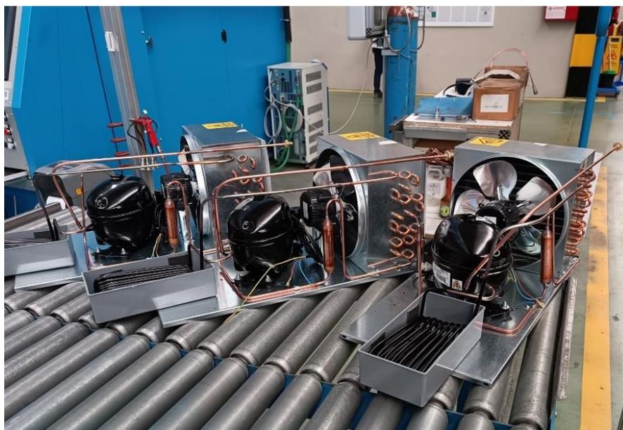
*Ilustración 19. Unidades de Condensación para Máquinas Frigoríficas*
