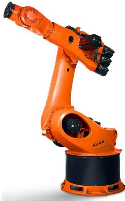
*Ilustración 31. Robot Antropomórfico KUKA 360 KR FORTEC*
