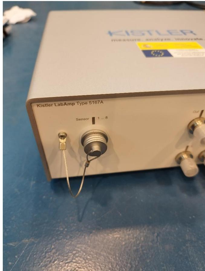
**Figura 25. Tapón de seguridad amplificador.**
