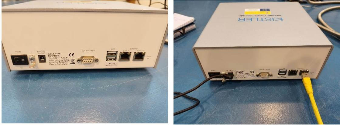
**Figura 27. Conexión cable de alimentación y de red.**
