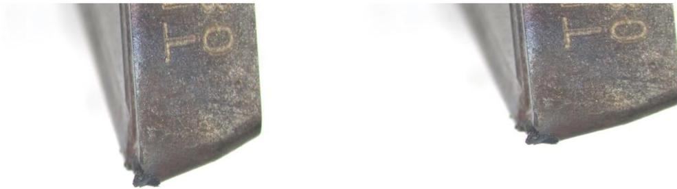
**Figura 99. Rotura herramienta de corte.**
