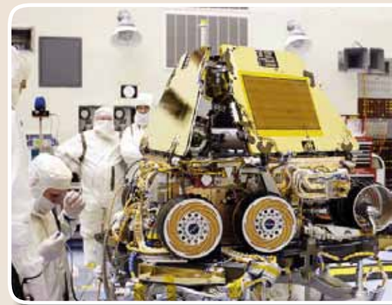
Científicos de la NASA preparan el rover MER-2 para su misión a Marte en Primavera de 2003. En el centro, vista panorámica del Spirit aterrizando en Marte. / Fotos: NASA
