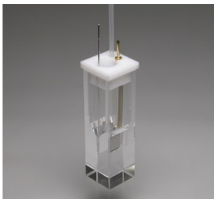
Figura 2.32.- Celda espectroelectroquímica empleada en los registros Vis-NIR y Raman.
