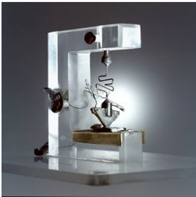
Figura 1.3.- (a) Fotografía del primer transistor (germanio) inventado en los laboratorios Bell. (b) Transistor de germanio fabricado por la compañía Bell Telephone en 1950.
