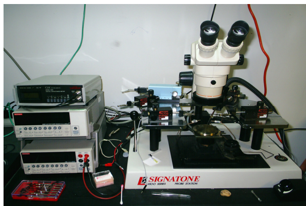
Figura 2.34.- Equipo para caracterización de OFETs bajo condiciones atmosféricas.
