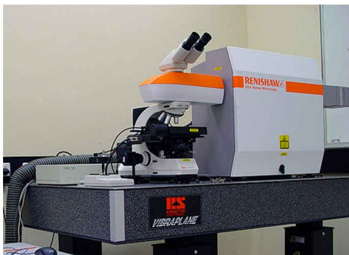
Figura 2.28.- Microscopio Invia Reflex Raman.
