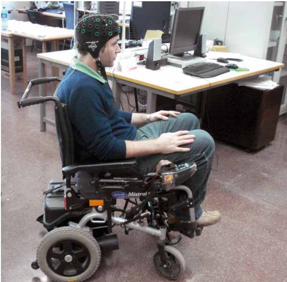
Prototipo de control de una silla de ruedas a través de un sistema BCI llevado a cabo por el grupo de investigación DIANA (Proyecto INTENTIA).
