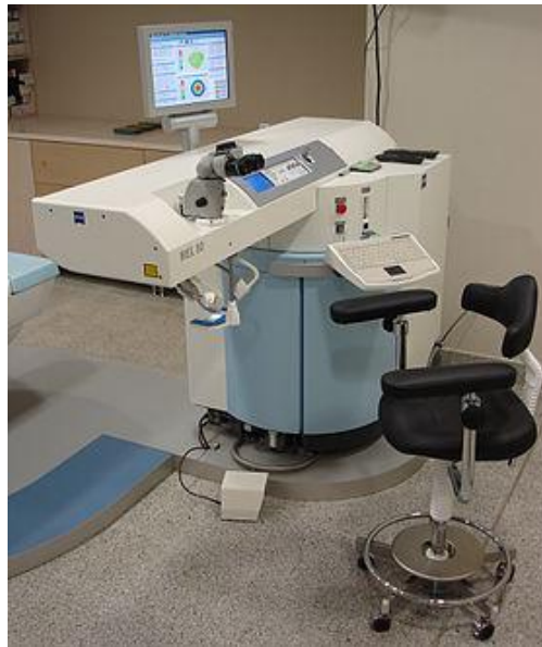
Figura 4.7 Láser de excímero empleado en cirugía oftalmológica para tratamientos LASIK. Equipamiento de la marca Carl Zeiss [Carl Zeiss, 2012]
