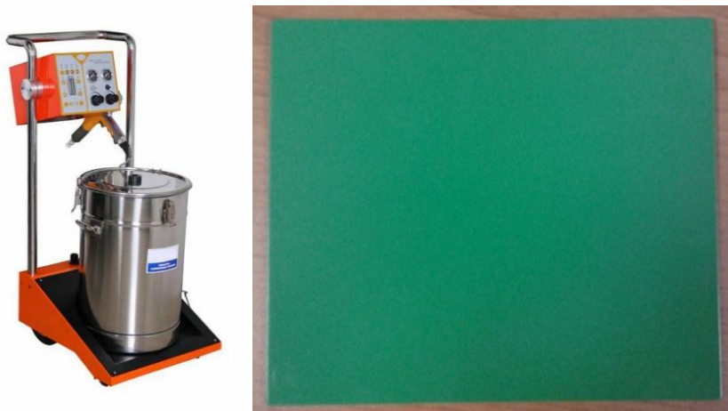
Figura 5.53 Equipo para aplicación de polvo de FEP (izquierda). Probeta recubierta de FEP (derecha)
