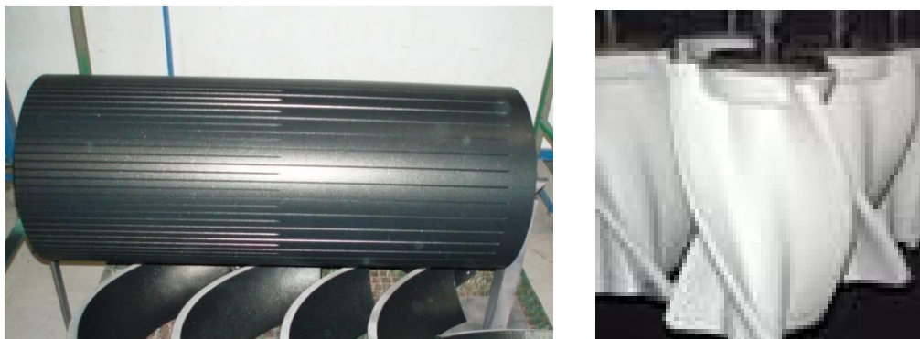
Figura 2.13 Recubrimientos con fluoropolímeros en equipos para amasado en panificación, [Tecnimacor, 2012(b)]
