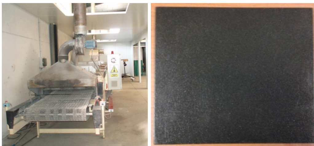
Figura 5.51 Equipo de polimerizado de la capa intermedia y final del PTFE (izquierda). Probeta recubierta de PTFE (derecha)
