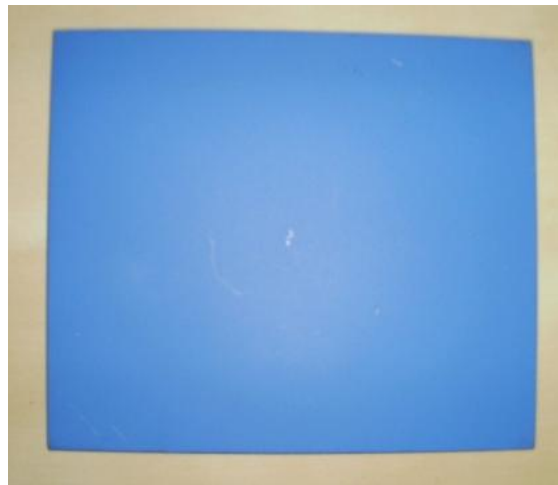
Figura 5.49 Probetas de aluminio EN- AW-5251 H34 tras la imprimación Marlite X-Treme 135.500 Z Blue . Posteriormente se aplicó una capa intermedia Marlite X-Treme 235.490z Nero Met y, por último, una capa final sin secado previo de la capa intermedia de Marlite X-Treme 245.491 Nero Metallizzato Finish . Se terminó con un ciclo de polimerizado de la capa intermedia y final que se realizó en un horno continuo (Figura 6.30 izquierda). Este ciclo es recomendado por el fabricante del producto y exige, al menos, alcanzar la temperatura de 400 a 420 °C durante 5 minutos (Figura 5.50).
