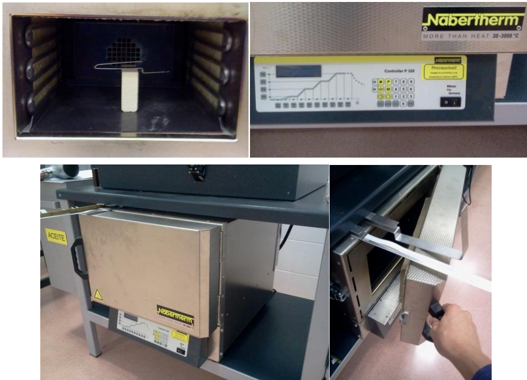
Figura 5.54 Posición de la probeta dentro de la unidad de tratamientos térmicos (arriba izquierda). Programador del equipo de tratamientos térmico, (arriba derecha). Equipo (abajo izquierda). Regla para el control del enfriamiento (abajo derecha)
