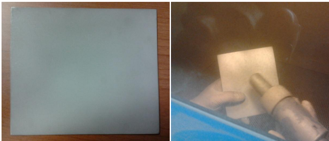
Figura 5.66 Aspecto de las placas de los experimentos tras la remoción por pirólisis (izquierda) y el acabado con chorreado manual (derecha)
