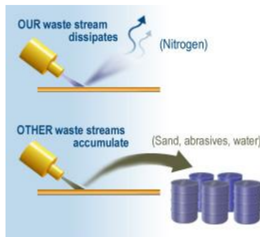
Figura 3.9 Comparación de la extracción con nitrógeno con otras técnicas [Nitrocisión, 2012]
