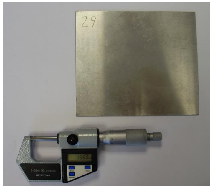
Figura 5.85 Micrómetro Mitutoyo de apreciación 0,001 mm
