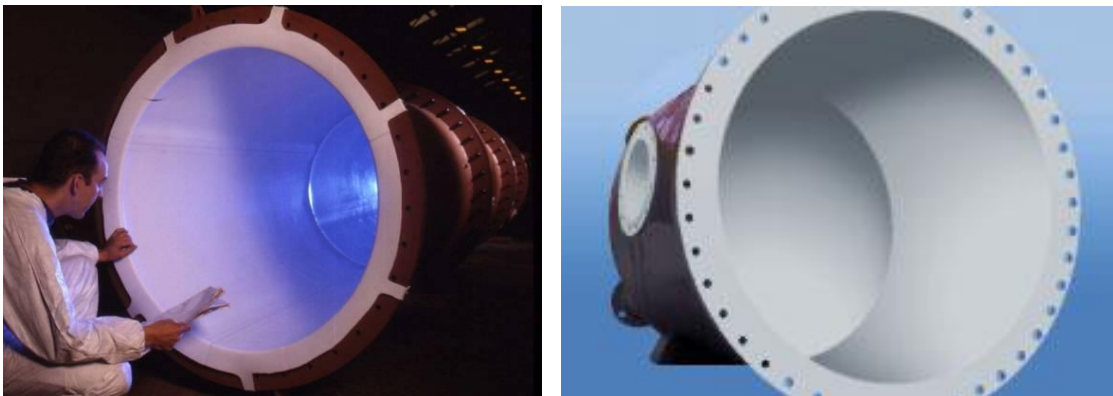
Figura 2.17 Recubrimientos con fluoropolímeros en aplicaciones en el sector químico, [Ebnesajjad et al, 2004] [Smalti Riva, 2012]
