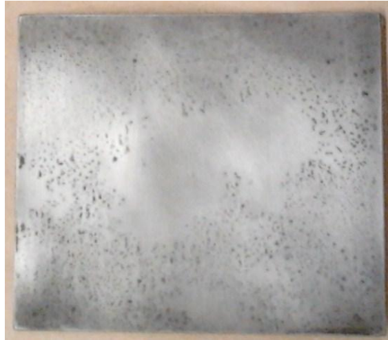
Figura 6.5 Placa recubierta de FEP tras la remoción láser (aún se detectan restos de fluoropolímero)
