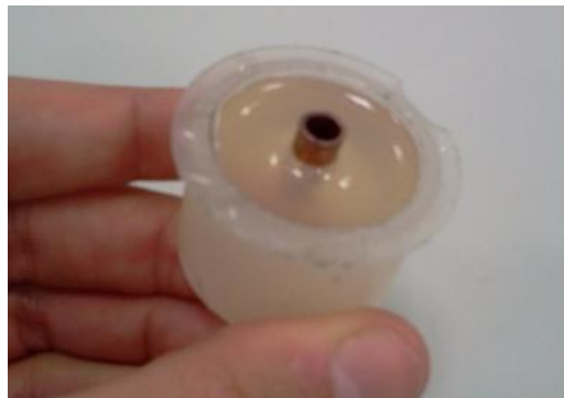
Figura 5.79 Vertido de resina en el molde de PVC con tubo de cobre insertado
