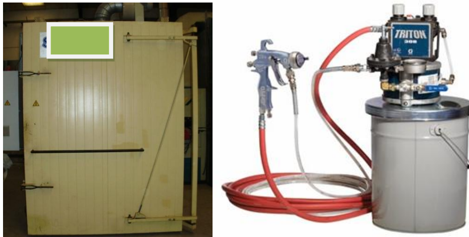
Figura 5.48 Horno para secado y/o polimerizado (izquierda). Equipo HVLV para aplicación de las formulaciones líquidas de PTFE (derecha)
