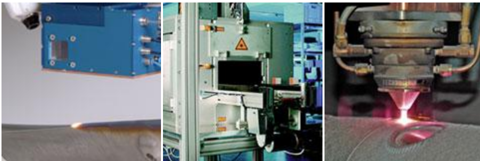
Figura 4.13 Aplicaciones de diodos láser. De izquierda a derechas: endurecimiento de metales, soldadura de plásticos y aplicación de revestimientos [Láserline, 2012]
