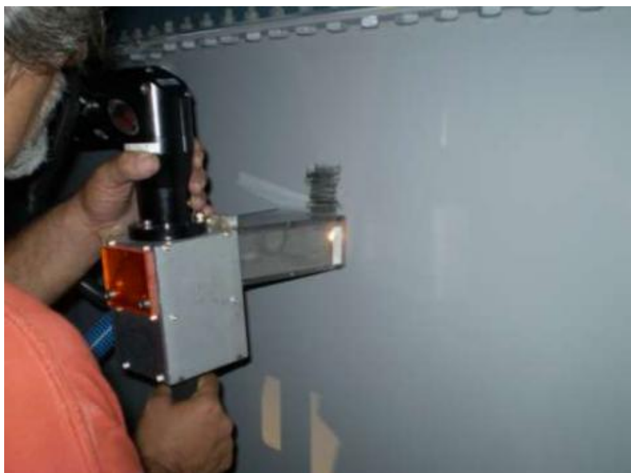
Figura 4.34 Aplicación de la remoción láser en depósitos de agua [Wolf et al, 2009]
