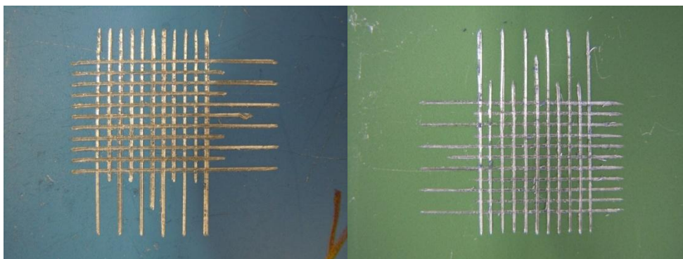
Figura 5.44(a) Aspecto de las cuadrículas en el ensayo de corte por enrejado UNE-ISO 2409:2007 en imprimación de PTFE (izquierda) y FEP (derecha)
