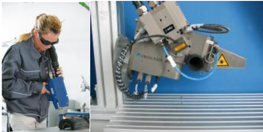
Figura 4.16 Equipo manual de ablación láser (izquierda), sistema automático de ablación (derecha) [Clean Láser, 2012]
