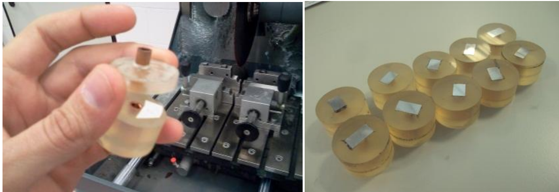
Figura 5.80 Corte de la probeta de resina para la preparación posterior en pulido (izquierda). Serie de probetas preparadas para el pulido (derecha)
