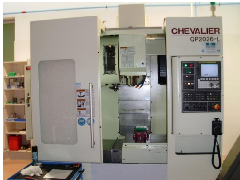
Figura 5.72 Centro de mecanizado Chevalier de 3 ejes de CNC Control de CNC Fanuc Oi
