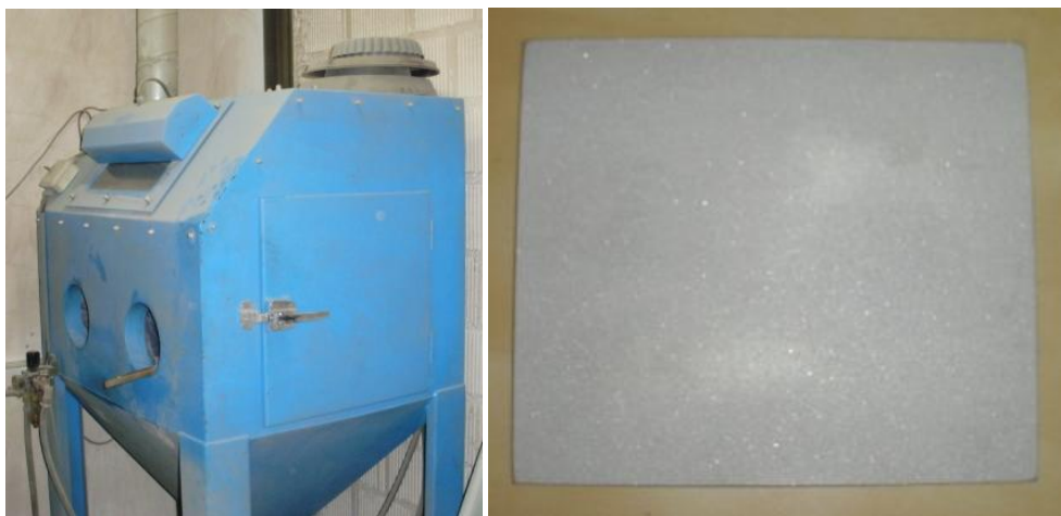
Figura 5.47 Equipo de chorreado manual (izquierda). Probetas de aluminio EN- AW-5251 H34 en estado de recepción tras el chorreado (derecha)
