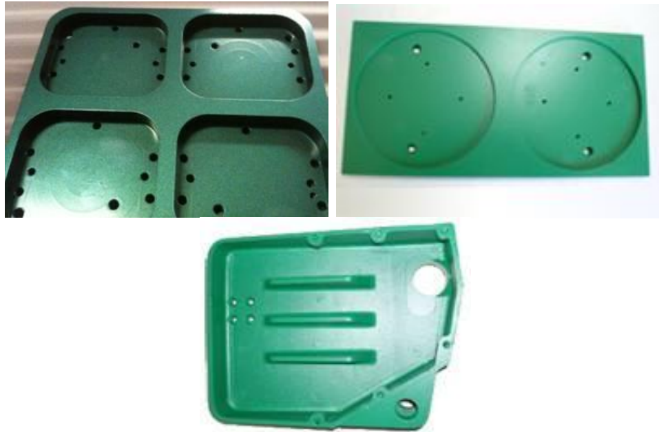
Figura 2.14 Recubrimientos con fluoropolímeros para diversos tipos de moldes [Tecnimacor, 2012(c)]
