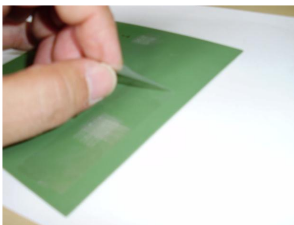
Figura 5.44 (b) Procedimiento de aplicación del ensayo de adhesión
