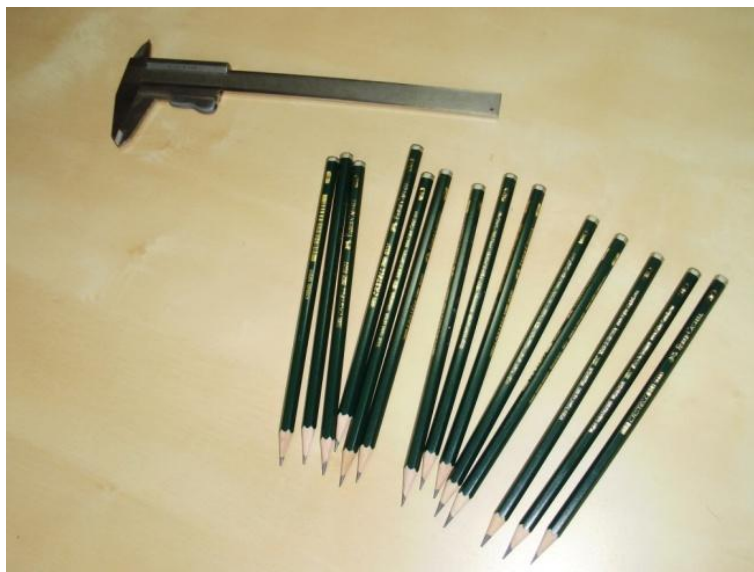
Figura 5.40 Juego de lápices utilizado en el ensayo de dureza lápiz [UNE 48269, 1995]
