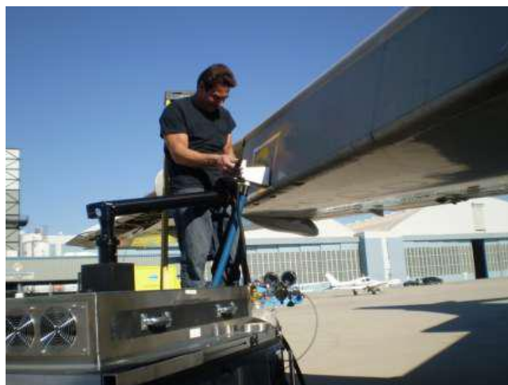
Figura 4.33 Aplicación de la remoción láser en aeronaves [Wolf et al, 2009]
