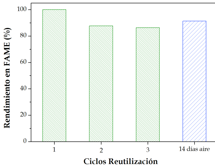
Figura 4.23.- Ciclos de reutilización del catalizador y estabilidad después de 14 días al aire (4% en peso cincato cálcico, relación molar metanol:aceite de 12:1, 60 °C, 1 hora y 600 rpm)
