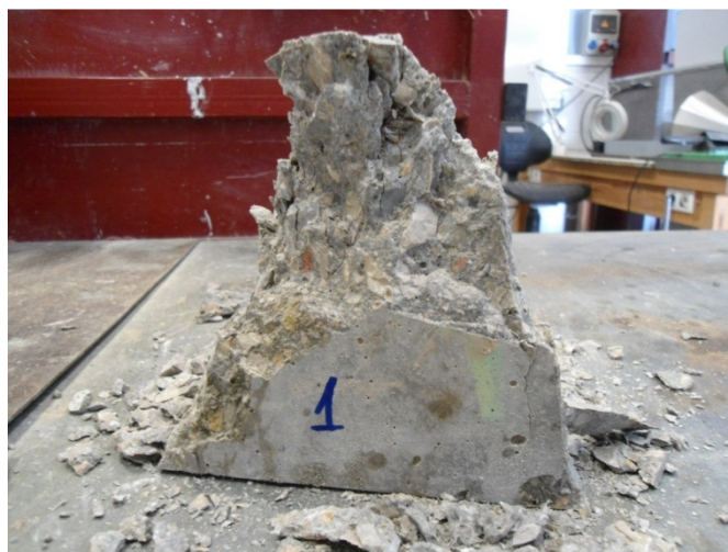
Figura 5.19. Rotura por explosión
