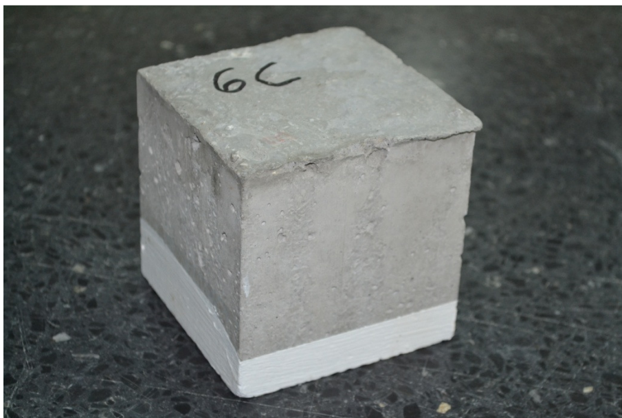
Figura 5.7. Impermeabilización de caras laterales en el ensayo de succión
