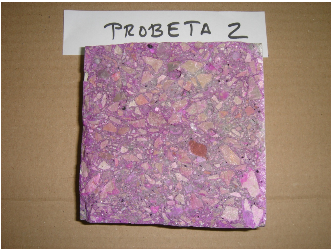
Figura 5.74. Probeta rociada con fenolftaleína para la determinación de la profundidad de carbonatación
