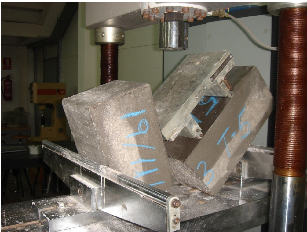
Figura 5.39. Rotura de probeta finalizado el ensayo de flexotracción
