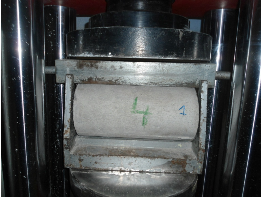
Figura 5.27. Probeta colocada en prensa de rotura con adaptador para la realización del ensayo brasileño
