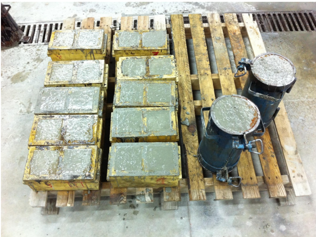
Figura 3.24. Fracción de probetas en estado fresco tras el proceso de fabricación
