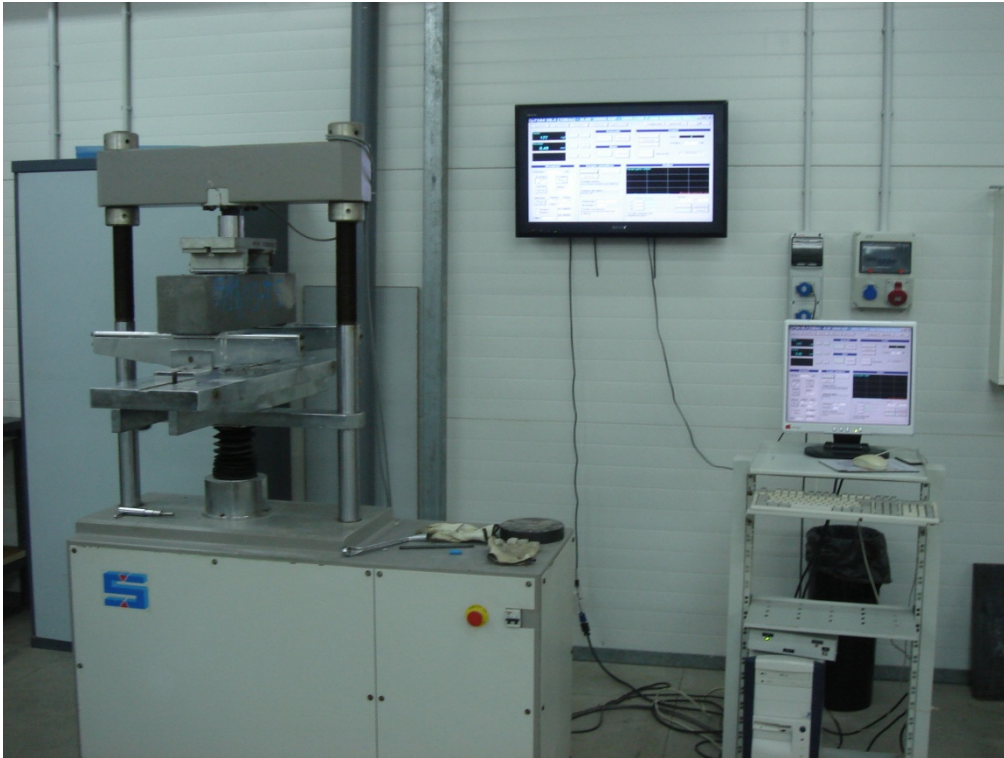
Figura 5.37. Equipo utilizado en el ensayo de flexotracción
