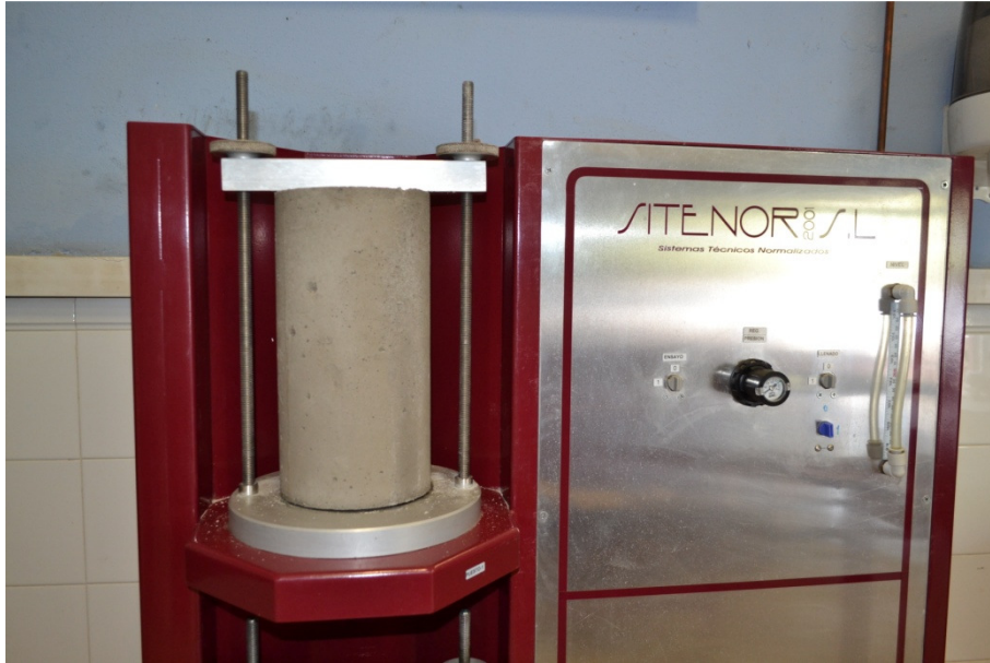
Figura 5.11. Detalle de probeta montada en equipo durante el ensayo de permeabilidad al agua bajo presión
