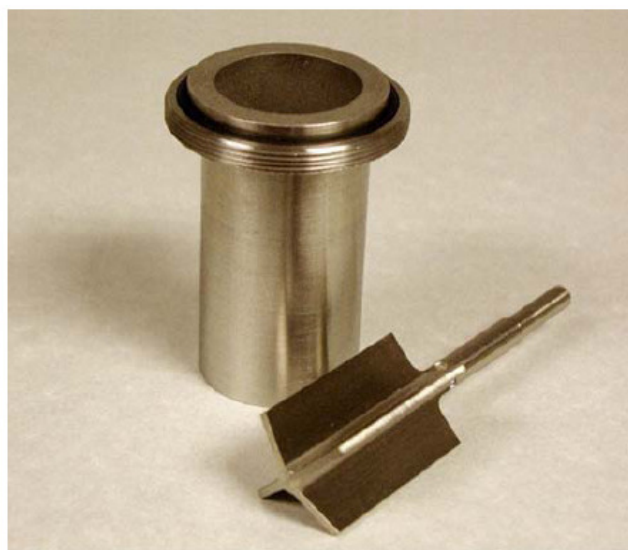
Figura 4.9. Geometría de vanos utilizada en este estudio
