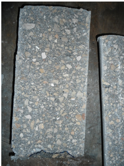
Figura 5.12. Frente de penetración de agua y calca sobre papel milimetrado para determinar la penetración máxima y media del hormigón
