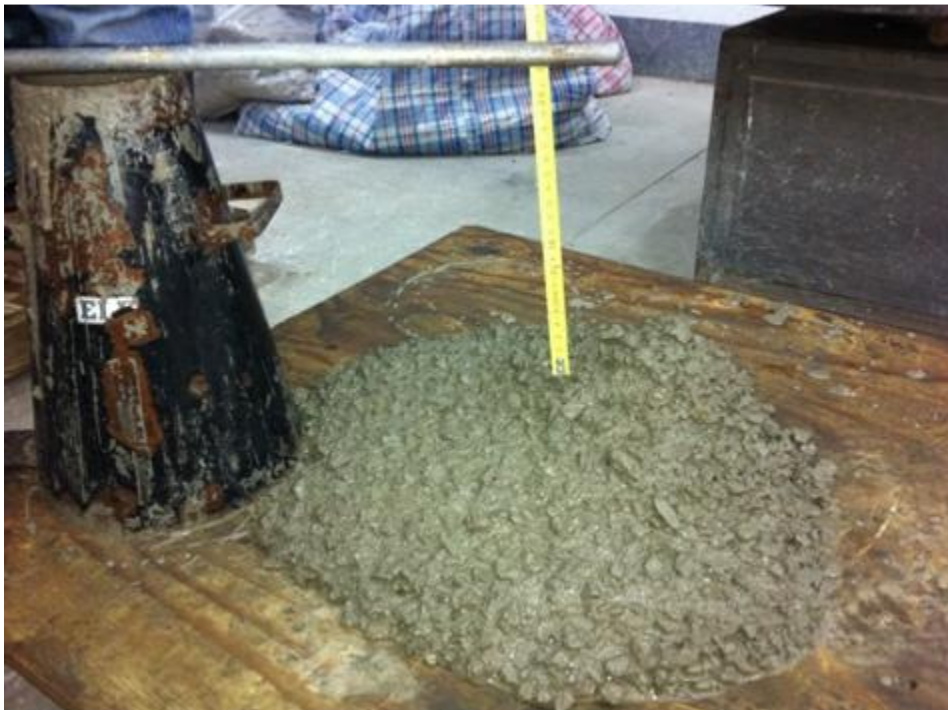
Figura 4.13. Resultado del cono de de Abrams para el hormigón tipo HSA
