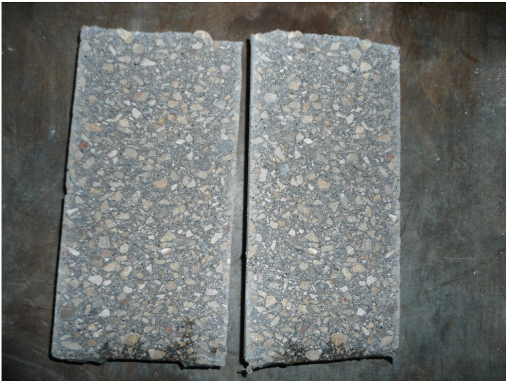
Figura 5.28. Secciones de probeta tras el ensayo brasileño
