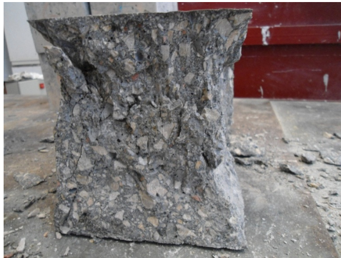
Figura 5.18. Rotura en forma de hiperboloide
