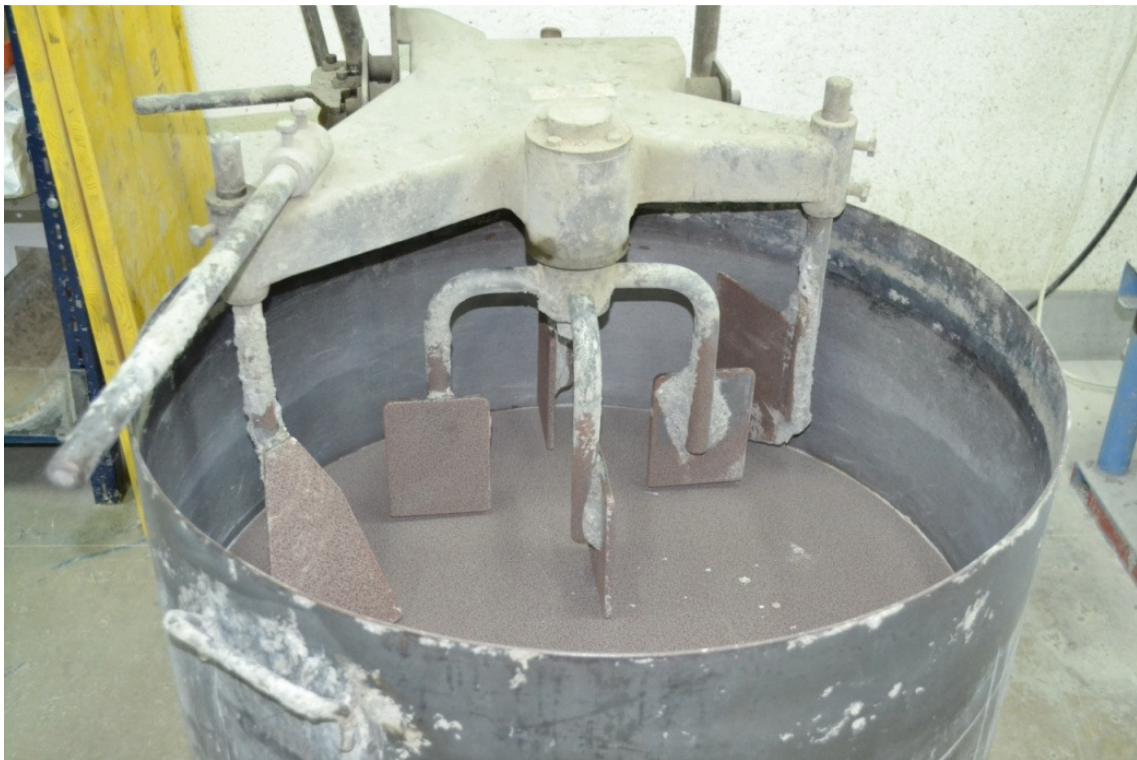
Figura 3.21. Hormigonera utilizada en la fabricación de probetas
