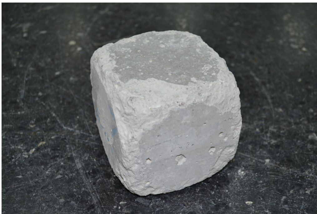
Figura 5.56. Estado de la probeta tras el ensayo Cántabro
