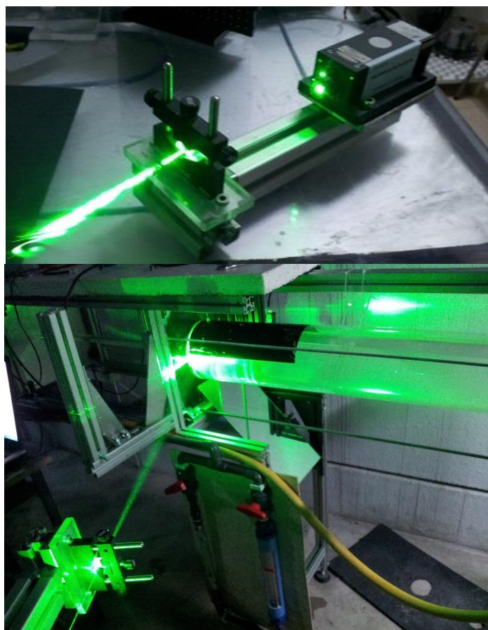
Figura 2.13. Detalle del Láser modelo DPSS 532 .
