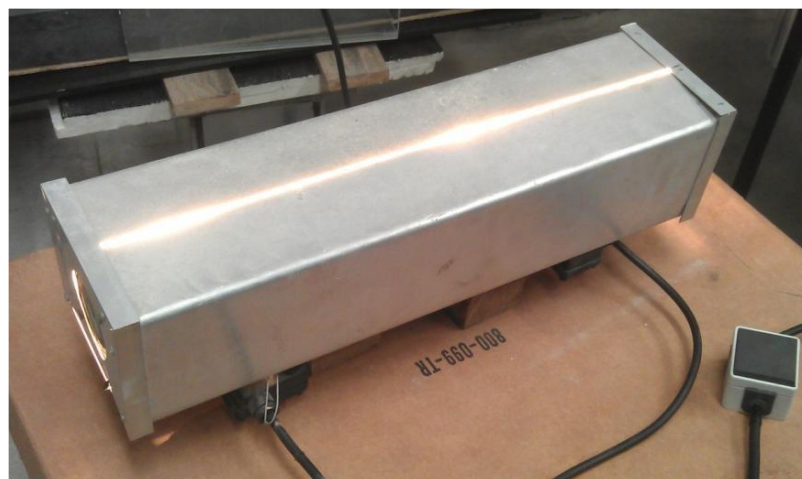
Figura 2.14. Detalle de la lámpara halógena utilizada en la visualización de los fenómenos que ocurren en la zona de aguas arriba y aguas abajo en el conducto que gira.
