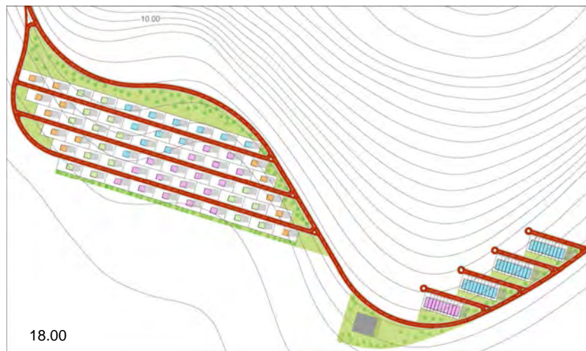
Figura 326: Fuengirola. Modelo optimizado. Período cálido. Proyección horaria de sombras (17.00h-20.00h). Fuente: Elaboración propia mediante el software Ecotect®.
