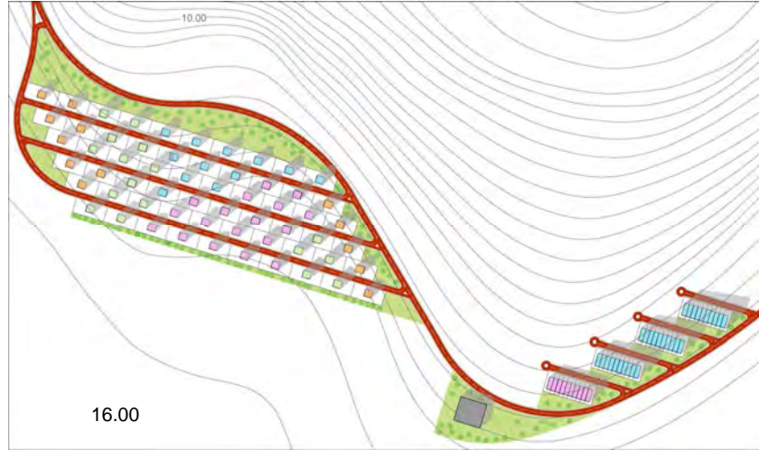
Figura 322: Fuengirola. Modelo optimizado. Período frío. Proyección horaria de sombras (16.00h). Fuente: Elaboración propia mediante el software Ecotect®.
