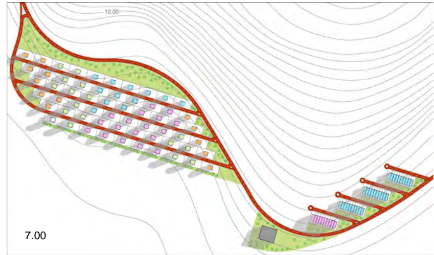
Figura 323: Fuengirola. Modelo optimizado. Período cálido. Proyección de sombras (6.00h-7.00h). Fuente: Elaboración propia mediante el software Ecotect®.
