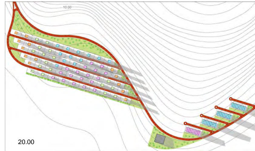
Figura 326: Fuengirola. Modelo optimizado. Período cálido. Proyección horaria de sombras (17.00h-20.00h). Fuente: Elaboración propia mediante el software Ecotect®.
