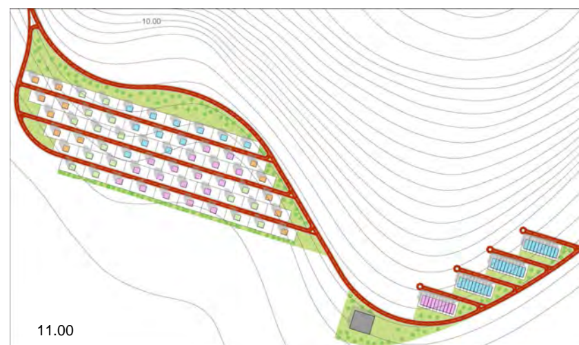
Figura 320: Fuengirola. Modelo optimizado. Período frío. Proyección horaria de sombras (8.00h-11.00h). Fuente: Elaboración propia mediante el software Ecotect®.
