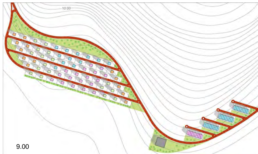
Figura 320: Fuengirola. Modelo optimizado. Período frío. Proyección horaria de sombras (8.00h-11.00h). Fuente: Elaboración propia mediante el software Ecotect®.
