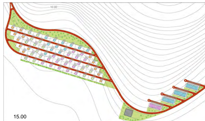
Figura 321: Fuengirola. Modelo optimizado. Período frío. Proyección horaria de sombras (12.00h-15.00h). Fuente: Elaboración propia mediante el software Ecotect®.
