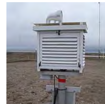
Figura 36: Armario contenedor de termómetro en estación meteorológica. Fuente: http://www.ign.es/espmmap/figuras_clima_bach/Clima_fig_01.htm
