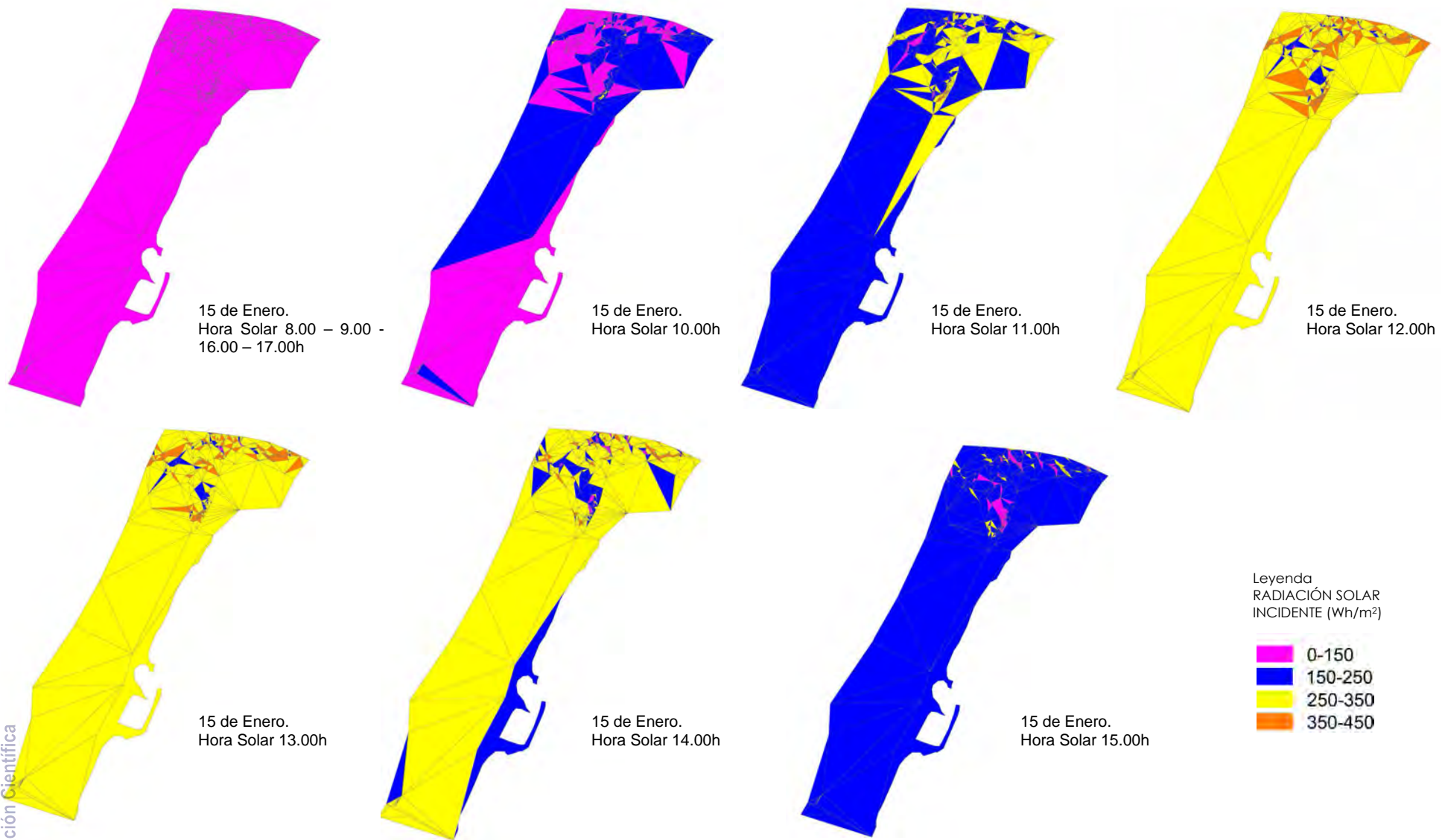
Figura 234: Representación gráfica de la radiación solar horaria (13.00h – 17.00h) impactada sobre los diferentes planos que configuran el territorio. Núcleo urbano de Fuengirola. Mes de Enero. Fuente: Elaboración propia mediante el levantamiento y análisis con el software Ecotect Analysis 2011®.
