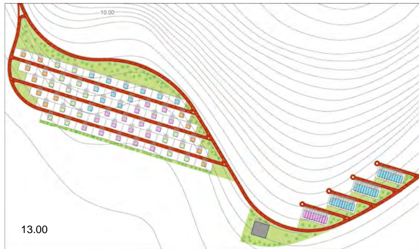
Figura 321: Fuengirola. Modelo optimizado. Período frío. Proyección horaria de sombras (12.00h-15.00h). Fuente: Elaboración propia mediante el software Ecotect®.
