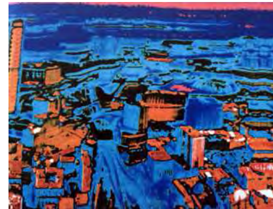
Figura 68: Izq.: determinación de "islas calientes" en una ciudad a través de una termografía.
