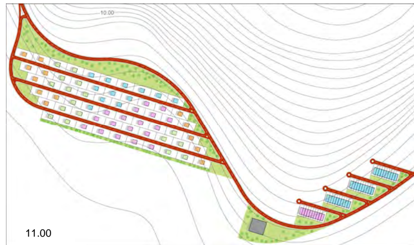
Figura 324: Fuengirola. Modelo optimizado. Período cálido. Proyección horaria de sombras (8.00h-11.00h). Fuente: Elaboración propia mediante el software Ecotect®.
