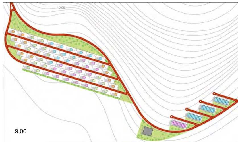
Figura 324: Fuengirola. Modelo optimizado. Período cálido. Proyección horaria de sombras (8.00h-11.00h). Fuente: Elaboración propia mediante el software Ecotect®.
