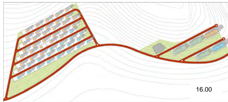
Figura 313: Estepona. Modelo optimizado. Período frío. Proyección horaria de sombras (8.00h-13.00h). Fuente: Elaboración propia mediante el software Ecotect®.
