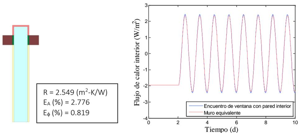
Figura 6: Resultados del ajuste de muro equivalente para un puente térmico formado en el encuentro de una ventana con una pared interior [10].
