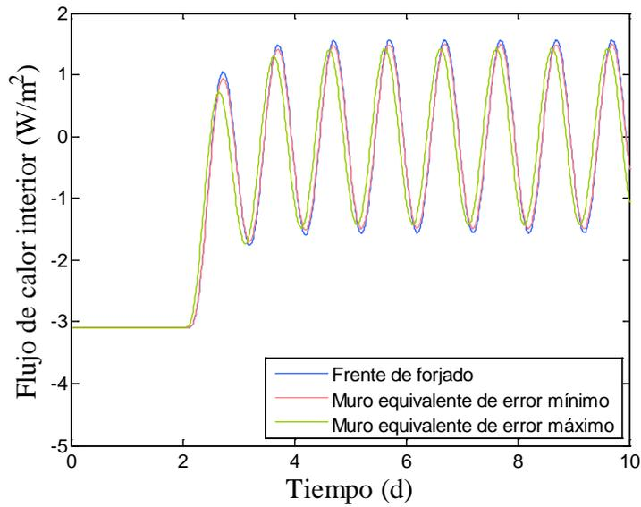
Figura 9: Comparación de las respuestas ante excitación sinusoidal exterior del frente de forjado (figura 7) y sus muros equivalentes de error máximo y mínimo.
