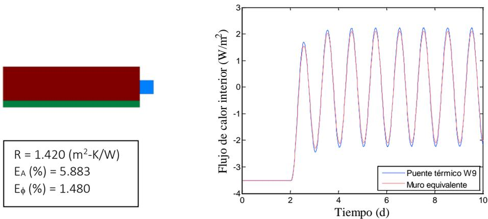
Figura 4: Resultados del ajuste de muro equivalente para un puente térmico formado en el alféizar de una ventana tipo W9 [9].
