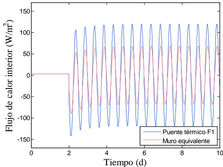
Figura 8: Comparación de los flujos de calor interior por  $\text{m}^2$  entre el puente térmico F1 (figura 2) y su muro equivalente ante excitación sinusoidal interior de período doce horas.
