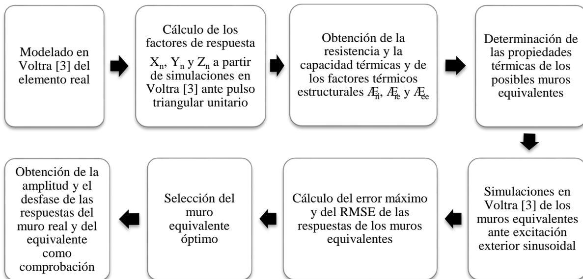
Figura 1: Esquema de implementación del método del muro equivalente automatizado con Matlab [6].
