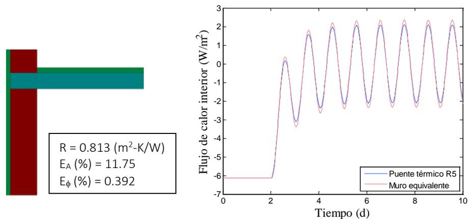
Figura 3: Resultados del ajuste de muro equivalente para un puente térmico formado en un tejado tipo R5 [9].
