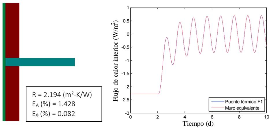
Figura 2: Resultados del ajuste de muro equivalente para un puente térmico formado en el encuentro de un forjado interior con muro exterior tipo F1 [9].
