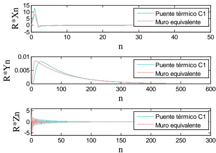
Figura 10: Comparación de los factores de respuesta del puente térmico C1 (figura 5) y de su muro equivalente.
