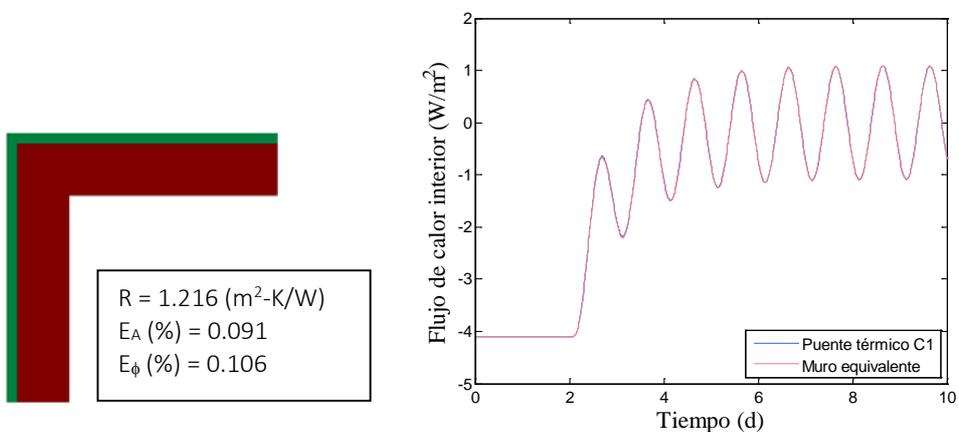
Figura 5: Resultados del ajuste de muro equivalente para un puente térmico formado en una esquina tipo C1 [9].
